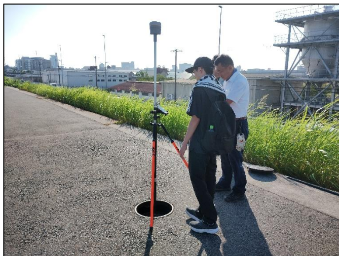
基準点の現況調査作業（水準点の標高検証）
